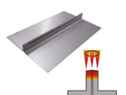
Die konzentrierte Wärmeeinbringung verhindert unnötiges Erwärmen des umliegenden Materials und reduziert damit die Gesamtwärme und den thermischen Verzug.
